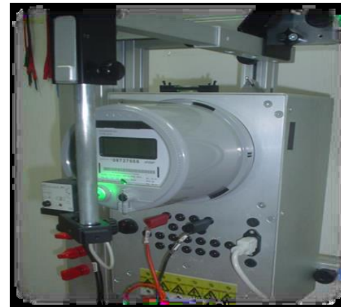
Mesa de prueba de medidores de energía eléctrica
